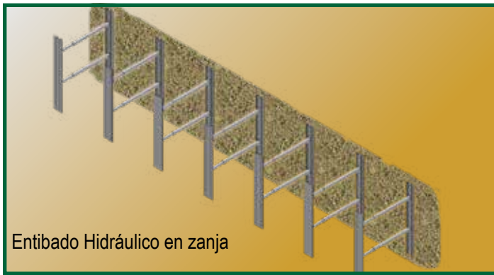
Entibado Hidráulico Vertical con dos cilindros
