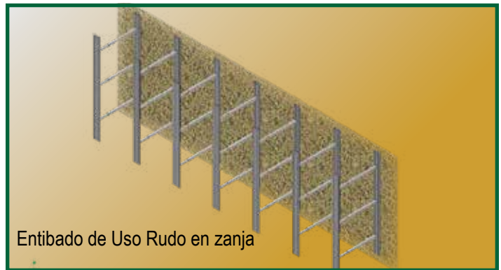
Entibado Vertical de Uso Rudo con tres cilindros
